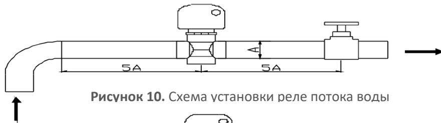
Рисунок 10. Схема установки реле потока воды
