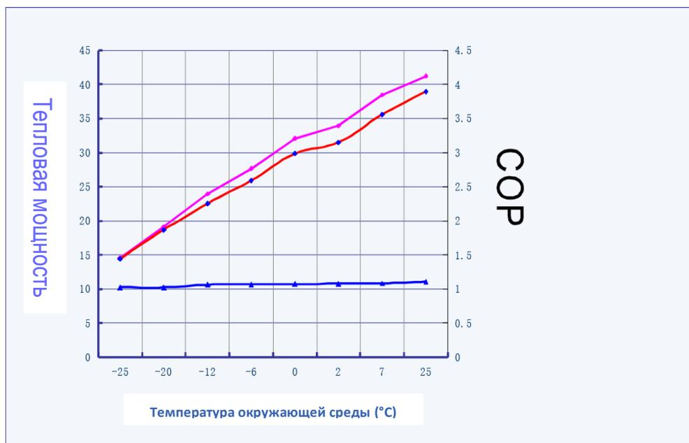
Если температура окружающей среды составляет  $-25^{\circ}\text{C} \sim 0^{\circ}\text{C}$ , энергоэффективность снизится. Кроме того, пожалуйста, обратите внимание на антифриз в водопроводной трубе устройства.
